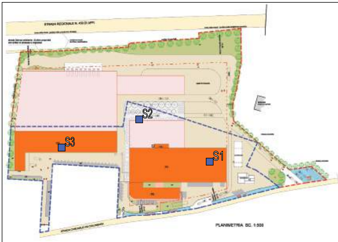
Fig. 9 – Posizione dei sondaggi (S)
